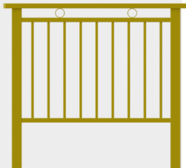
**Structure** : Poteaux en tube rectangulaire 80 x 40 mm / 2 lisses en tube carré 35 x 35 mm. Main courante en tube rectangulaire 80 x 40 mm avec aux extrémités des embouts métalliques inarrachables de forme arrondis. Motif barreaux en tube carré 20 x 20 mm / Espacement inférieur à 110 mm.
