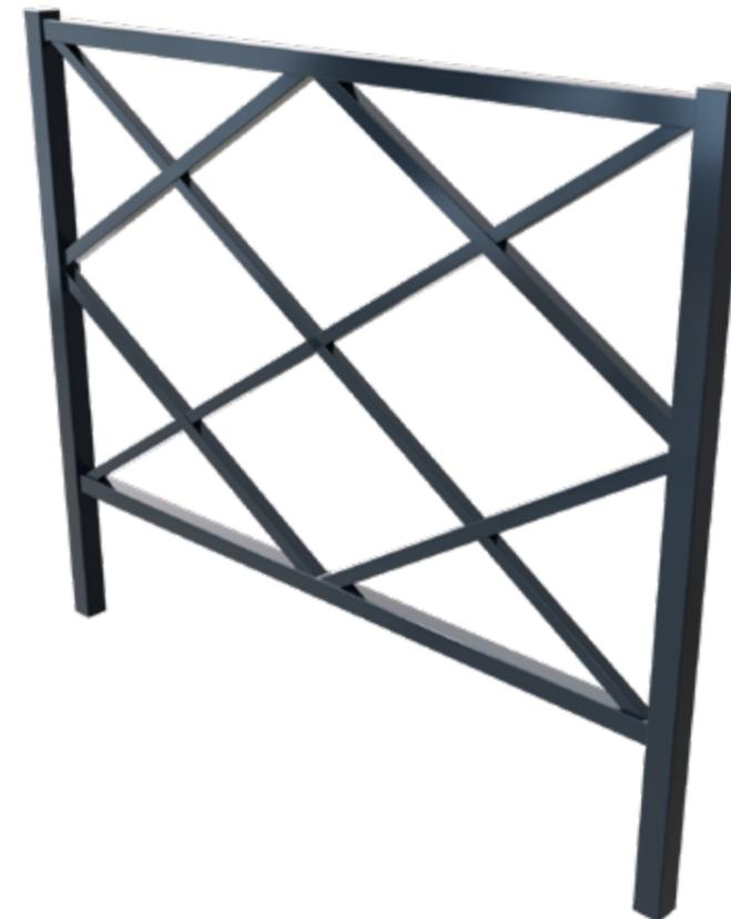
**Structure :** Poteaux en tube carré 50 x 50 avec aux extrémités des bouchons métalliques soudés et meulés. Main courante et lisse basse en tube d'acier 40 x 40 mm. Tube en losange 30 x 30, et croix en tube 20 x 20.
