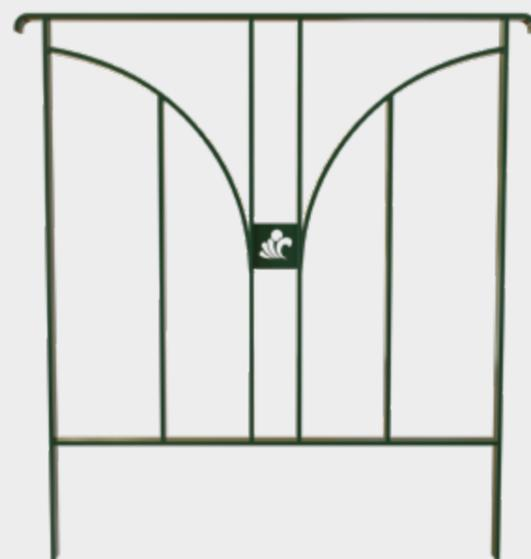
**Structure :** Montant latéraux en fer plat 40 x 10 mm. Main courante en fer plat 40 x 10 mm. Lisse en fer plat 40 x 10 mm. Motif central découpe laser sur carré 100 x 100 mm complètement personnalisable.
