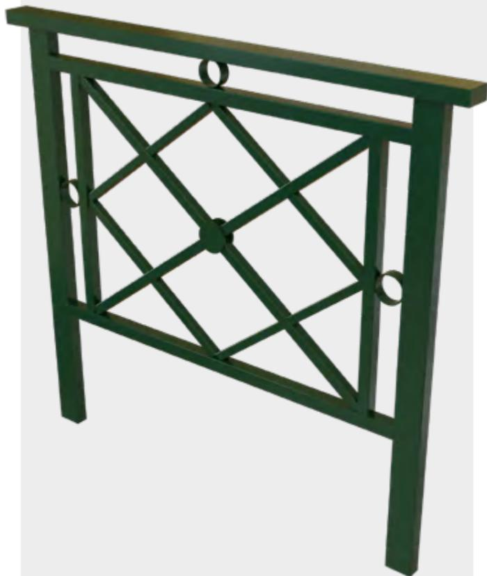
**Structure :** Poteaux en tube rectangulaire 80x40 mm. Main courante 80x40 mm avec embouts métalliques inarrachables de forme arrondie pour la sécurité. Lisse haute 40x40 mm. Lisse basse 40x40 mm.
