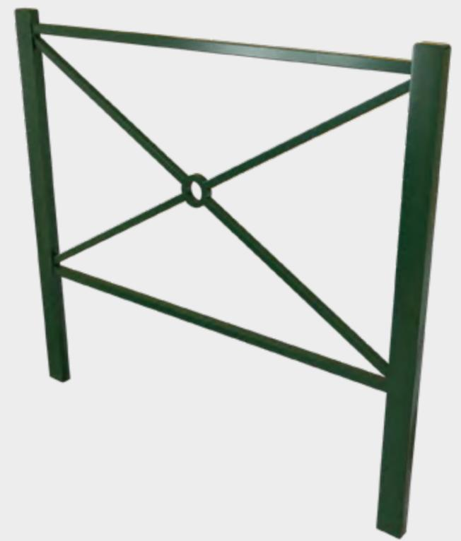
**Structure** : Poteaux en tube 80x40 mm avec aux extrémités des embouts métalliques inarrachables de forme arrondie. Main courante 30 x 30 mm. Lisse basse 30 x 30 mm. Motif croix en tube carré 25 x 25 mm.
