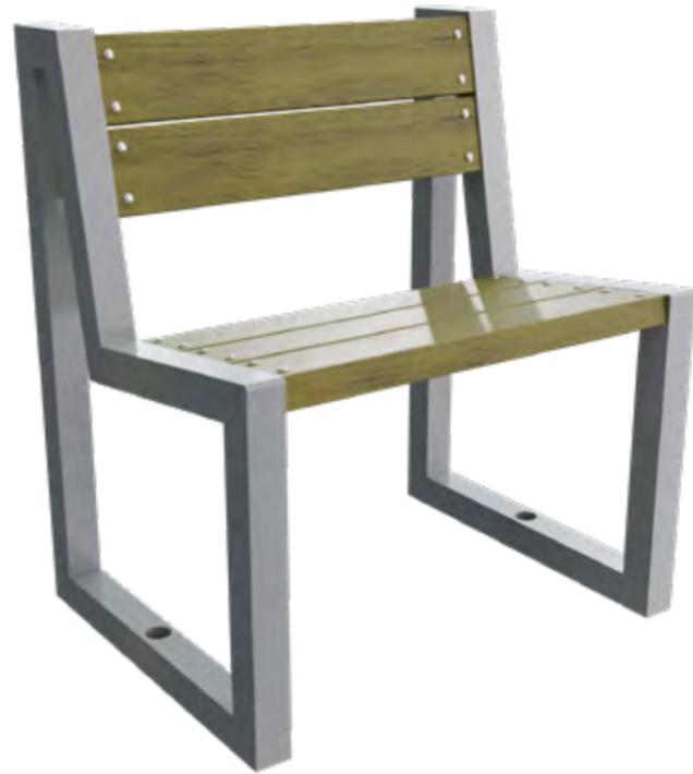
**Structure** : Piètement en tube carré 50 x 50 mm. Lames en bois autoclave classe IV. Arêtes arrondies pour la sécurité des usagers.
