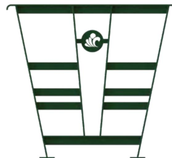
**Structure :** Montants latéraux en fer plat 50 x 10 mm. Main courante en fer plat 50 x 10 mm. Lisse en fer plat 50 x 10 mm. Motif logo en découpe laser.
