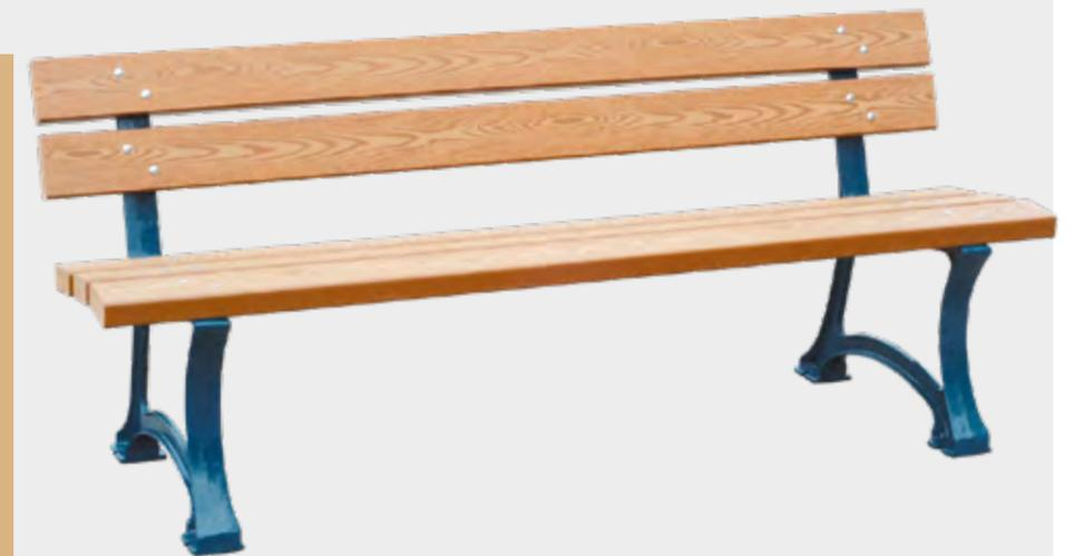
**Structure** : Piétement fonte. Lames en bois composite d'épaisseur 45 mm Arêtes arrondies pour la sécurité des usagers. Fixation des lames par boulons zingués.
