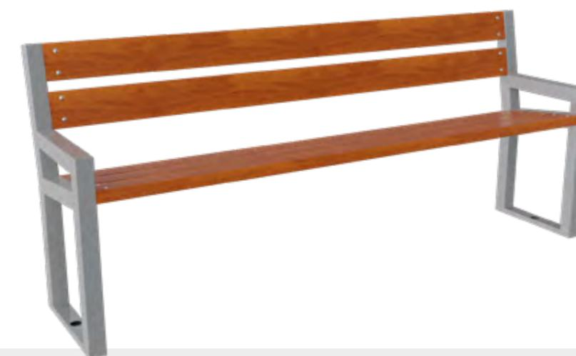
**Structure** : Piétement en tube carré 50 x 50 mm. Lames en bois d'épaisseur 35 mm. Arêtes arrondies pour la sécurité des usagers.
