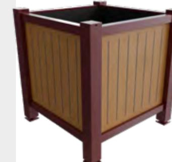
**Structure** : Poteaux en tube acier, 80 x 80 mm, terminés par une tôle soudée et meulée. Pieds réglables en hauteur permettant de s'adapter au relief du sol. Platine 80 x 80 mm, épaisseur 5 mm. Traverse horizontale en tube carré 50 x 50 mm.
