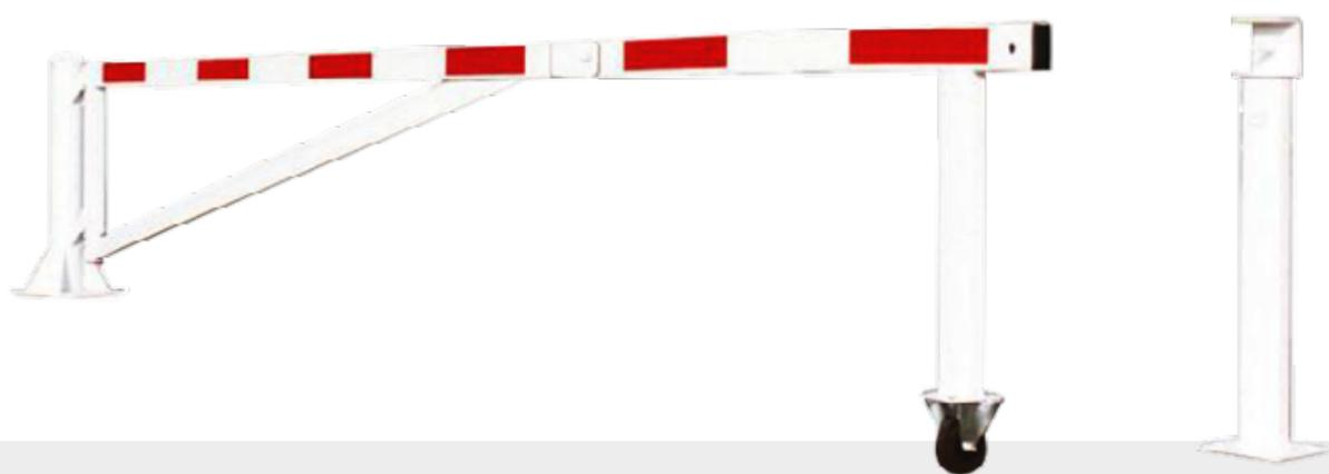
**Structure** : Lisse 100 x 50 x 3 mm et barre de renfort 80 x 40 mm pivotantes sur fût Ø 140 mm avec articulation pour absorber les dénivélés. Equipée d'un support roulotte qui limite le porte-à faux et facilite leur manipulation.
