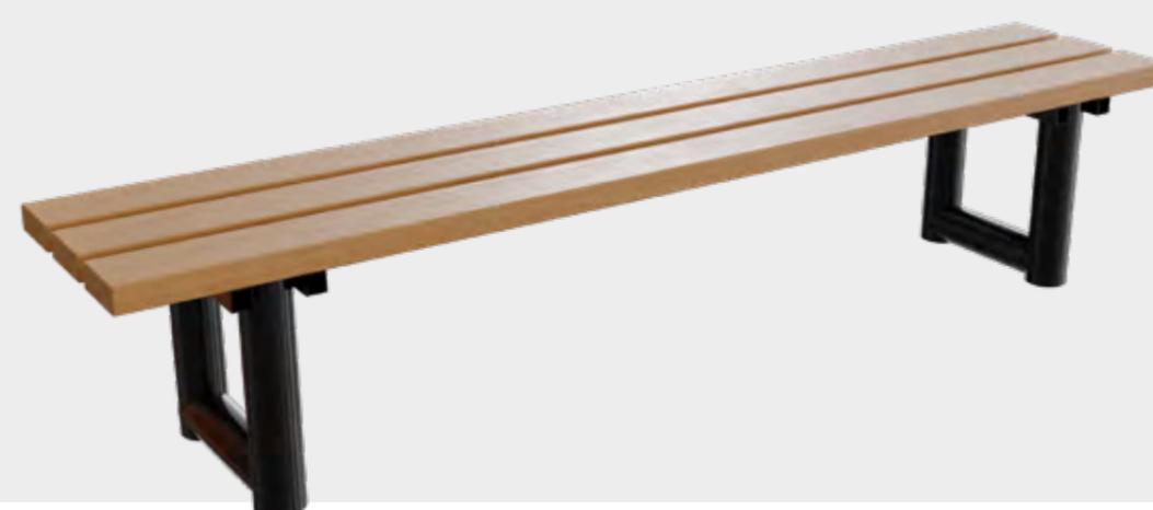
**Structure** : Piètements en tube rond Ø70 mm. Lames en bois composite épaisseur 45 mm. Arêtes arrondies pour la sécurité des usagers. Fixation des lames par boulon zingués. Banquette à sceller. Tiges de scellement fournies. Pied monobloc soudé.
