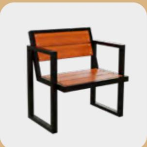
**Structure** : Piétement en tube carré 40x40 mm ainsi que support d'assise et dossier. Lames en bois exotiques massif d'épaisseur 35 mm.
