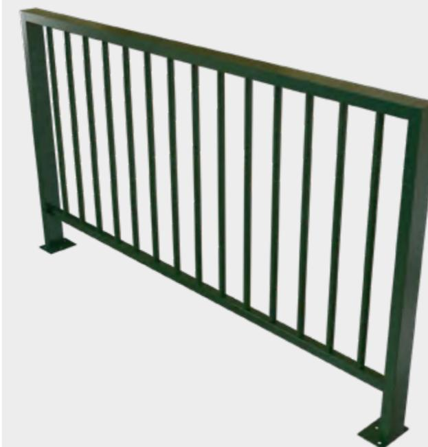
**Structure** : Main courante en tube rectangulaire de 80x40x2 mm. Poteaux en tube de 80x40x2 mm. lisse basse en tube de 35x35. Motif barreaux en tube de Ø 25 mm avec un espacement inférieur à 110 mm.
