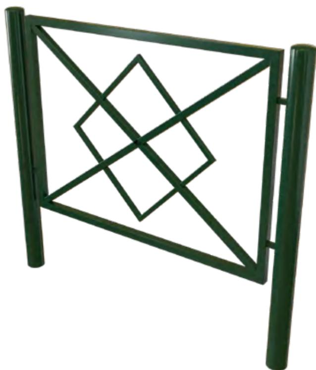
**Structure :** Poteaux en tube rond  $\varnothing$  88,9 mm avec en extrémité un fond bombé soudé et meulé. Cadre en tube 35 x 35mm. Motif intérieur en tube 30 x 30 et 20 x 20mm.
