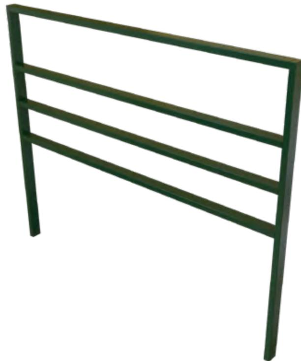
**Structure :** Montant 2 fers plats 40 x 10 mm. Main courante fer plats en T section 40 x 40 x 4 mm. 3 sous lisses section 30 x 10 mm avec deux montants carré plein 16 x 16 mm.
