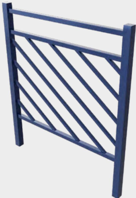
**Structure** : Poteaux latéraux en tubes 50 x 50 mm. Main courante 30 x 30 mm Lisse haute en tube : 30 x 30 mm. Lisse basse en tube : 30 x 30 mm. Motif 8 Barreaux inclinés en tube carré de 20 x 20 mm et espacés de 110 mm.
