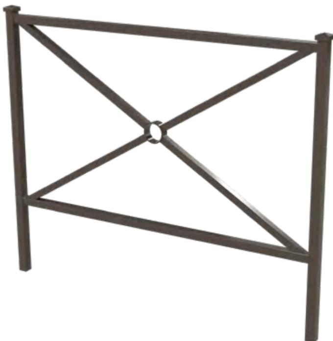
**Structure** : Structure lisse basse et main courante en tube carré 30 x 30 mm. Poteaux en tube carré 40 x 40mm. Intérieur croix en tube 30 x 20 mm.
