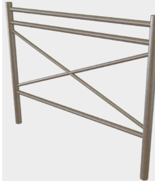
**Structure :** Poteaux ronds  $\varnothing$  60,3 mm épaisseur 2 mm avec en extrémité un fond bombé soudé et meulé. Main courante, lisse haute et lisse basse en  $\varnothing$  38 mm épaisseur 2 mm. Croix en tube  $\varnothing$  26,2 mm épaisseur 2 mm et  $\varnothing$  17,2 mm. Epaisseur 2 mm
