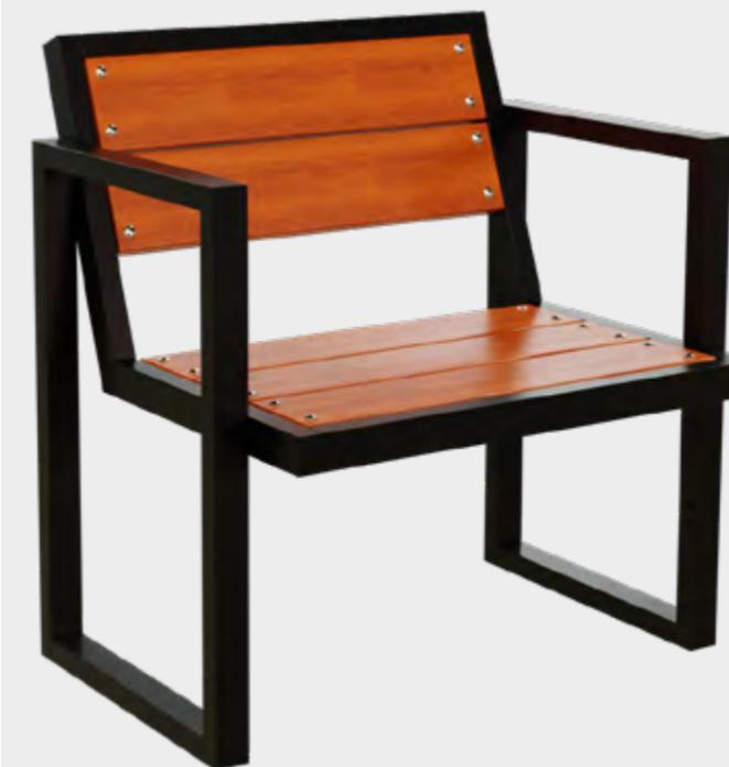
**Structure** : Piétements en tube carré 40 x 40 mm ainsi que support d'assise et dossier. Lames en bois exotiques massif d'épaisseur 35 mm.
