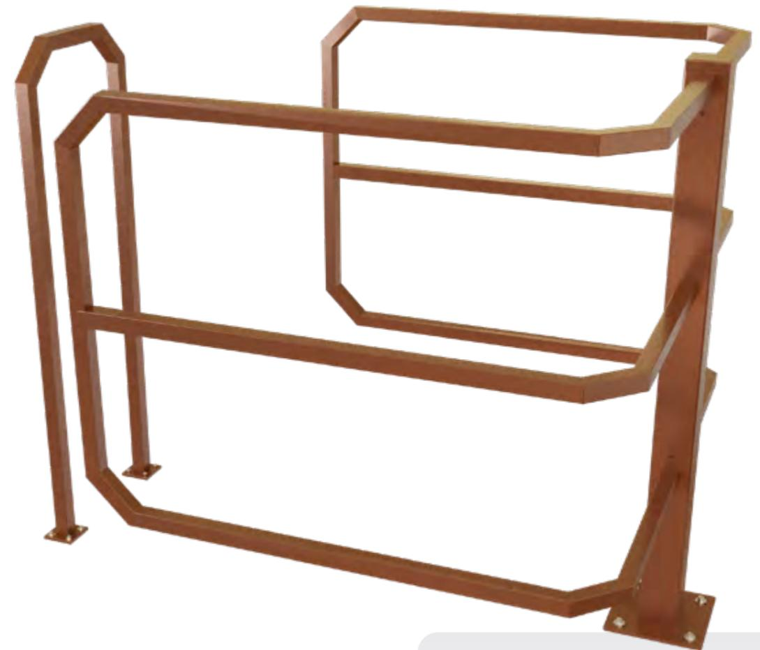
**Structure** : Tubes acier 40 X 40 mm (accroît la résistance et protège contre les dégradations volontaires) comprenant un élément rotatif et un élément fixe. Système d'ouverture : pivot assuré par un tube intérieur Ø 89 mm avec butée de limitation de rotation et tube supérieur 100 x 100 mm.
