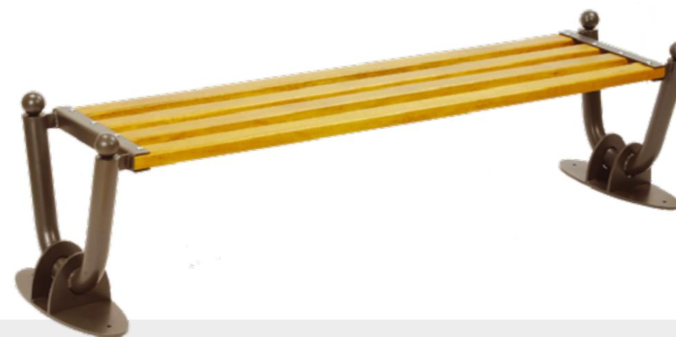
**Structure** : Piétement en tube rond  $\varnothing 60$  mm sur platines percées pour scellement au sol. Lames en bois exotiques massif d'épaisseur 40 mm. Arêtes arrondies pour la sécurité. Fixation des lames par boulons zingués.
