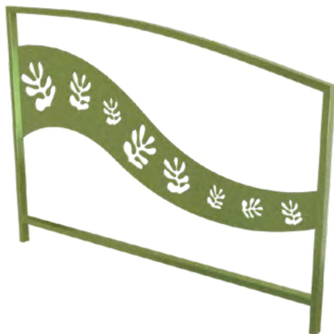
**Structure** : Poteaux en tube rectangulaire 40 x 27 mm. Main courante + lisse basse en tube rectangulaire 40 x 27 mm. Motif tôle en forme de vague épaisseur 5 mm en découpe laser type "feuille"
