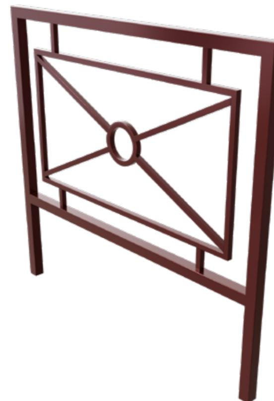
**Structure** : Poteaux en tube carré 50 x 50 mm. Main courante 50 x 50 mm. Lisse 50 x 50 mm. Motif croix en tube carré 25 x 25 mm et Rond central en acier plein épaisseur 25 mm
