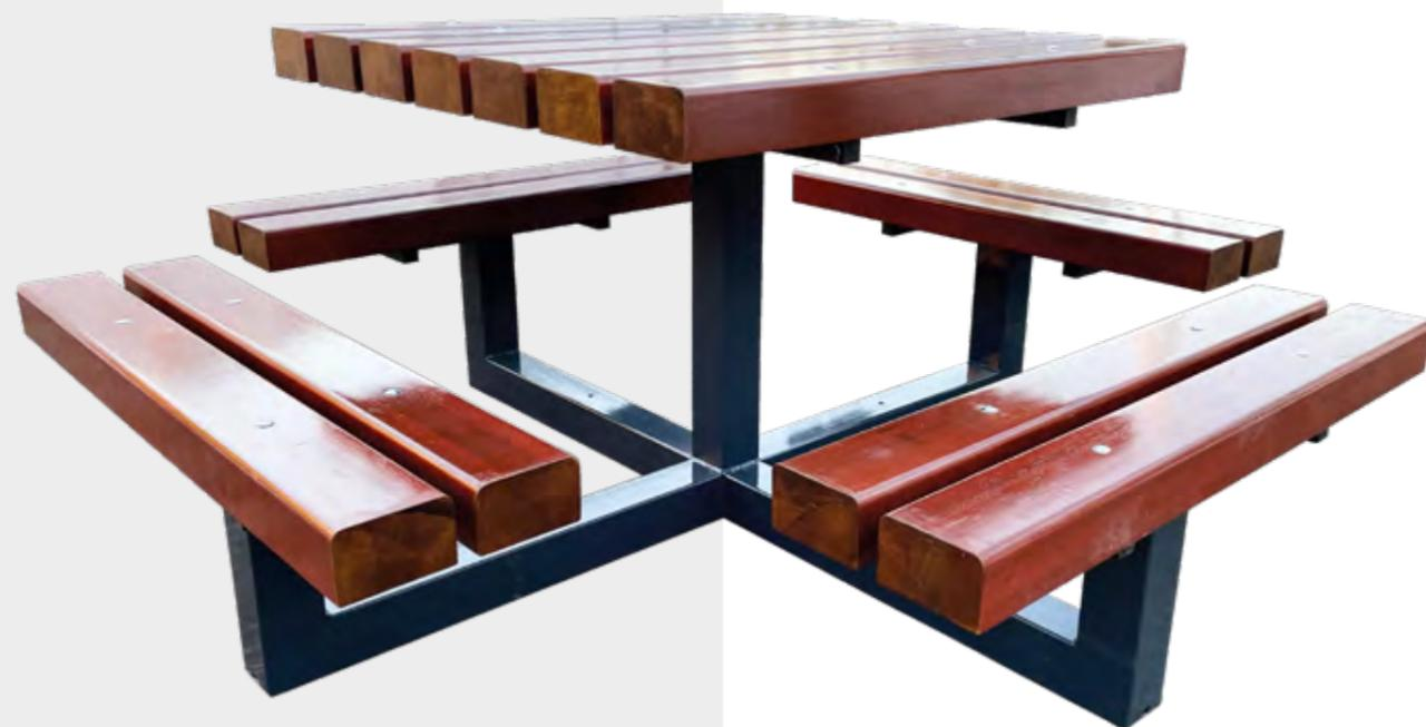
**Structure** : Piètement en tube carré 80 x 80 mm. Lames en bois exotique massif traité épaisseur 70 mm. Angles et arêtes arrondis pour la sécurité des usagers. Fixation des lames par boulons zingués.
