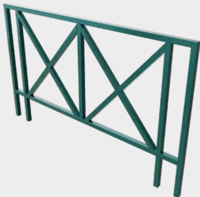
**Structure** : Poteaux en tube carré 40 x 40 mm. Main courante 40 x 40 mm. Lisse basse 40 x 40 mm. Motif croix en tube carré de 25 x 25 mm.
