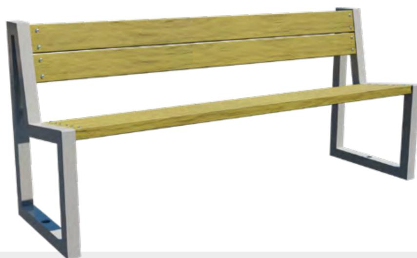
**Structure** : Piétement en tube carré 50 x 50 mm. Lames en bois autoclave classe IV. Arêtes arrondies pour la sécurité des usagers.
