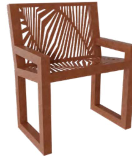
**Structure** : Piètements en tube carré 50 x 50 mm. Assise et dossier en tôle épaisseur 3 mm avec découpe laser soudé aux piètements pour plus de solidité.
