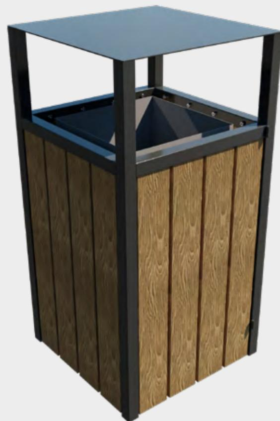
**Structure** : Corps de la corbeille réalisé en tube 35 x 35 mm. Fer plat de 5 mm d'épaisseur pré-perçés pour fixation au sol. Protège-pluie en tôle épaisseur 3 mm. Ouverture latérale. Verrouillage par serrure à clé. Lames en bois autoclave certifiées classe IV.
