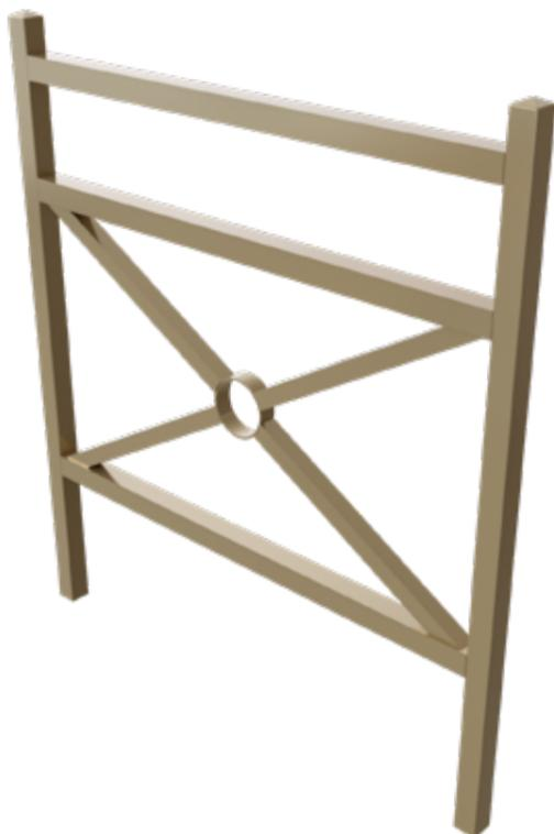
**Structure** : Poteaux en tube carré 50 x 50 mm avec embouts métalliques en forme de pointe de diamant. Main courante 40 x 40 mm + 2 Lisses 40 x 40 mm. Motif croix en tube rectangulaire 35 x 20 mm. Rond central en tube rond  $\varnothing$  101,6 mm épaisseur 3 mm.
