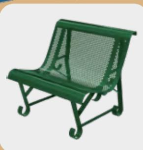
**Structure** : Assise en tôle perforée 15/10e, trous ronds  $\varnothing 8$  mm. Piètement en fer plat cintré 2 ou 3 pieds
