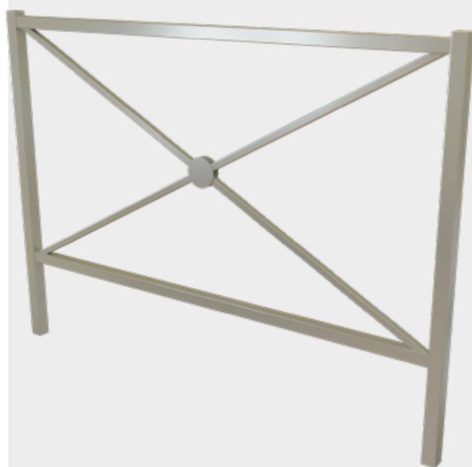
**Structure** : Poteaux en tube carré 40 x 40 mm avec en extrémité un bouchon en polypropylène noir. Main courante en tube carré 35 x 35 mm. Lisse basse 35 x 35 mm. Motif croix en tube carré 20 x 20 mm.
