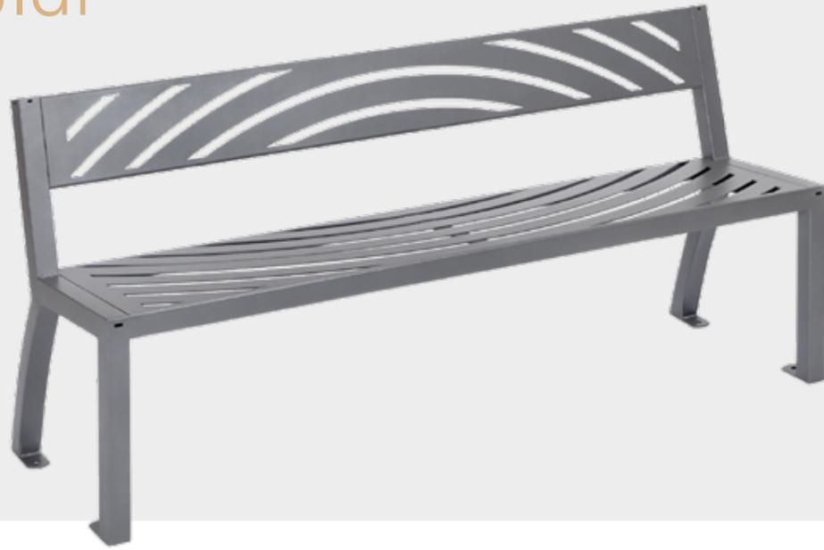
**Structure** : Piètement en tube carré 50x50 mm. Assise et dossier en tôle galvanisée épaisseur 3 mm avec découpe laser.
