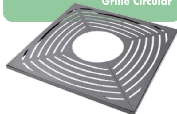
**Structure :** Grille en tôle galvanisée, épaisseur 3 mm, supportée par une armature renforcée métallique en tube acier. Ouverture pour le passage de l'arbre Ø600 mm. La grille est constituée de 2 éléments. Elle vient se poser sur un chassis périphérique également formé de 2 éléments en cornière de 40 x 40 mm épaisseur 4 mm.
