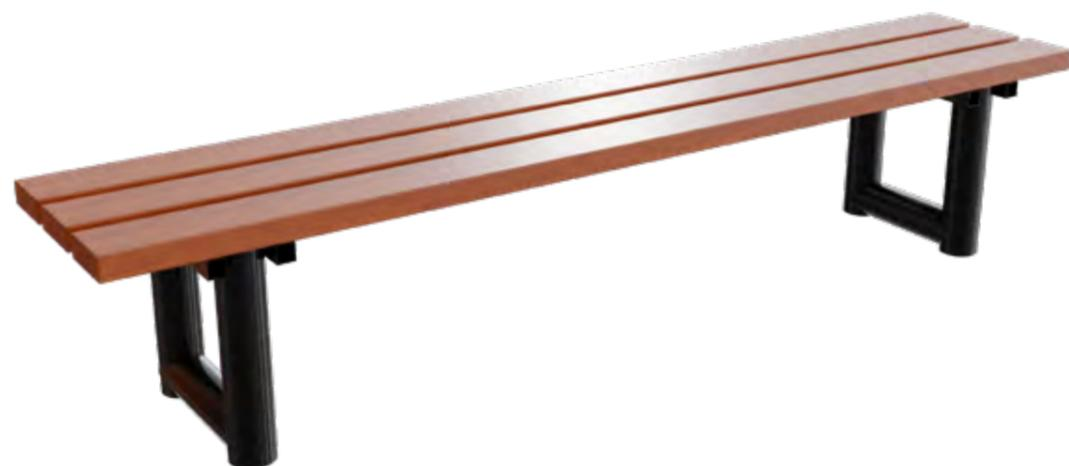
**Structure** : Piètements en tube rond Ø76 mm. Lames en bois exotique massif traité épaisseur 35 mm. Arêtes arrondies pour la sécurité des usagers. Fixation des lames par boulon zingués. Banquette à sceller. Pied monobloc soudé.
